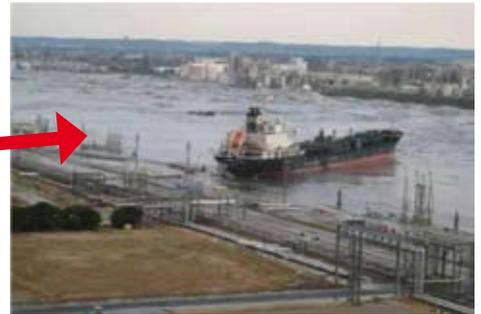
Un navire chimiquier arrache ses amarres à l'arrivée du tsunami dans le chenal intérieur sud du complexe, provoquant des dommages aux installations et quais de chargement
