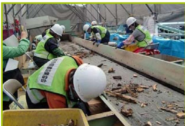
Chaîne de tri manuel des déchets du tsunami dans une zone provisoire de collecte et de tri de la préfecture de Miyagi (Source : UNEP)
